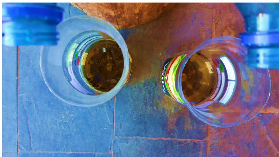
Imagen 6. Vista aérea de los sedimentos que cayeron del macetero sin vegetación.
